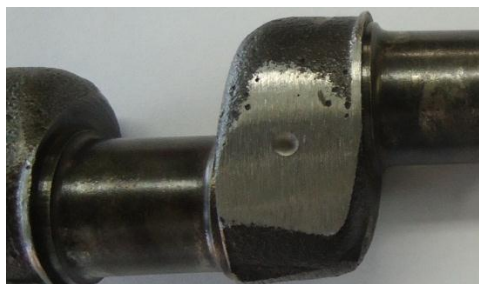
Figura 7. Região onde realizou a medição da dureza. (O autor, 2017)
