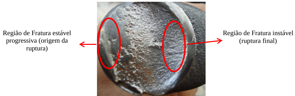
Figura 3: Seção de rompimento do virabrequim. (O autor, 2017)
