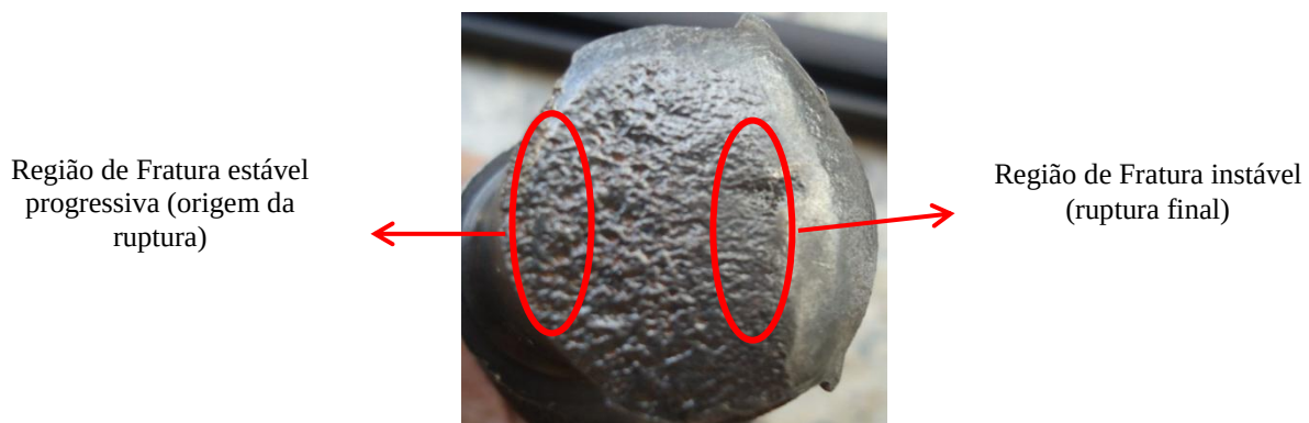
Figura 5: Imagem da região da fratura (O autor, 2017)
