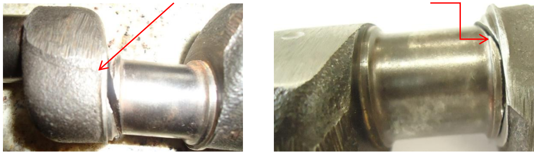
Figura 3: Seção de rompimento do virabrequim. (O autor, 2017)
