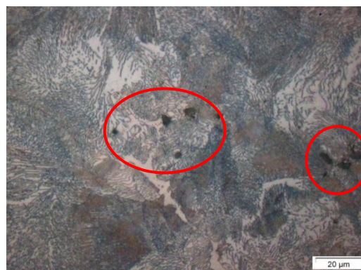
Figura 6. Metalografia do ferro fundido nodular (O autor, 2017)
