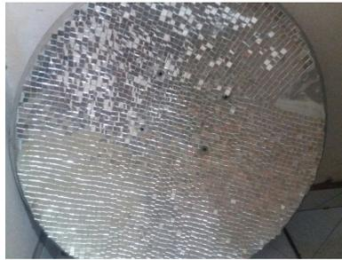
Figura 4: Antena Parabólica utilizada como concentrador solar
