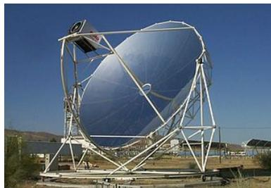
Figura 3: **Motor Stirling acoplado a um concentrador parabólico**
