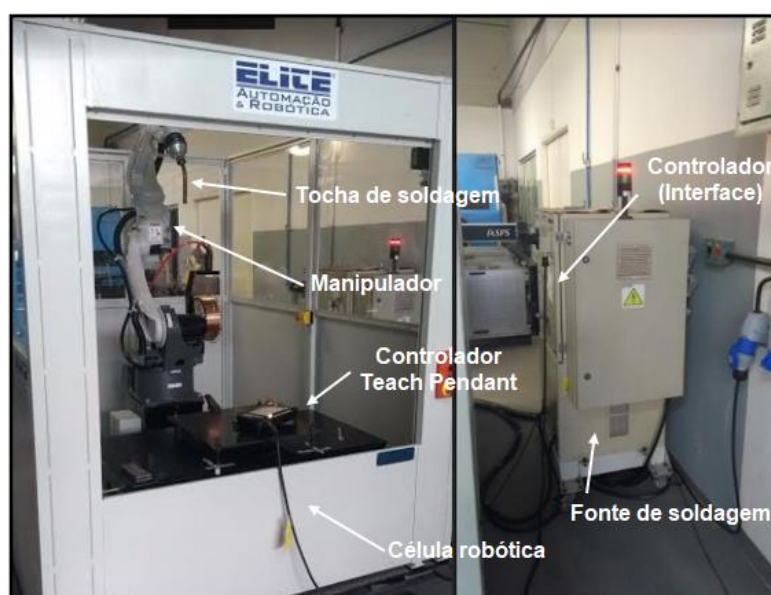
Figura 1 – Robô de soldagem Panasonic modelo TM -1400WGIII acoplado à célula robótica 20F1M.
