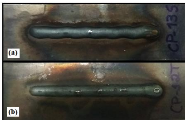
Figura 4 – Aspecto dos cordões no nível de energético de 800 kJ/m: (a) 13S-sólido; (b) 12T-tubular.
