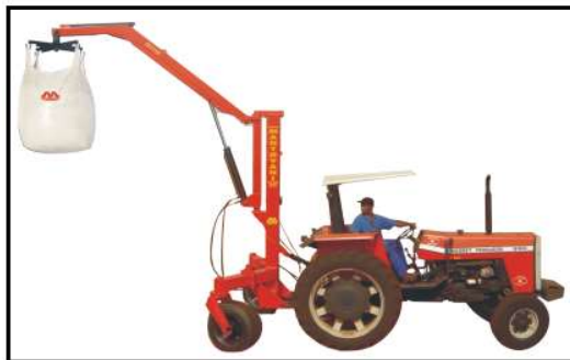
Figura 1. Guincho hidráulico 2.000 kg. Fonte: Arquivos da empresa, 2017.
