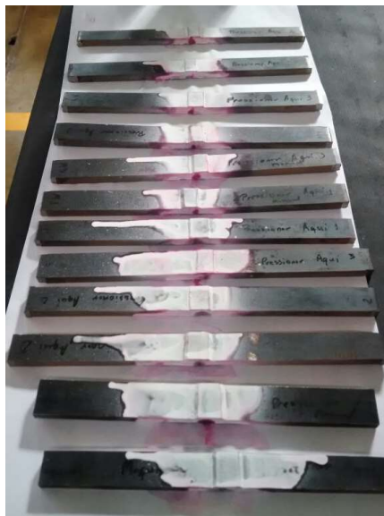
Figura 6. Ensaio não destrutivo por líquido penetrante. Fonte: UFTM, 2018.
