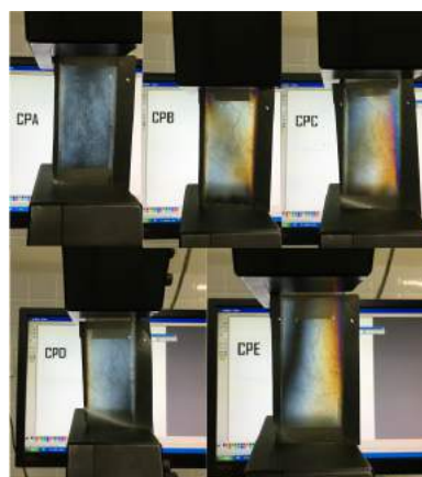
Figura 6. Tensões nos corpos de prova sem furo antes do ensaio de tração
