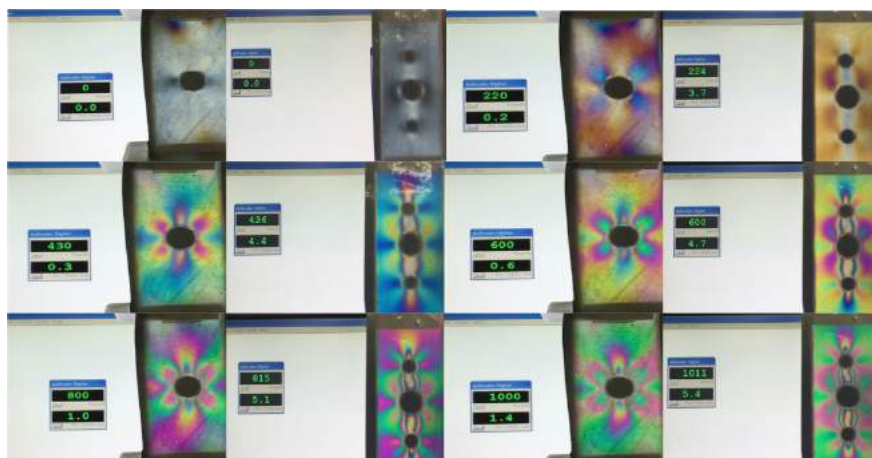
Figura 10. Comparação das franjas no corpo CPC, com um furo e com três furos, quando submetido a uma mesma carga de tração
