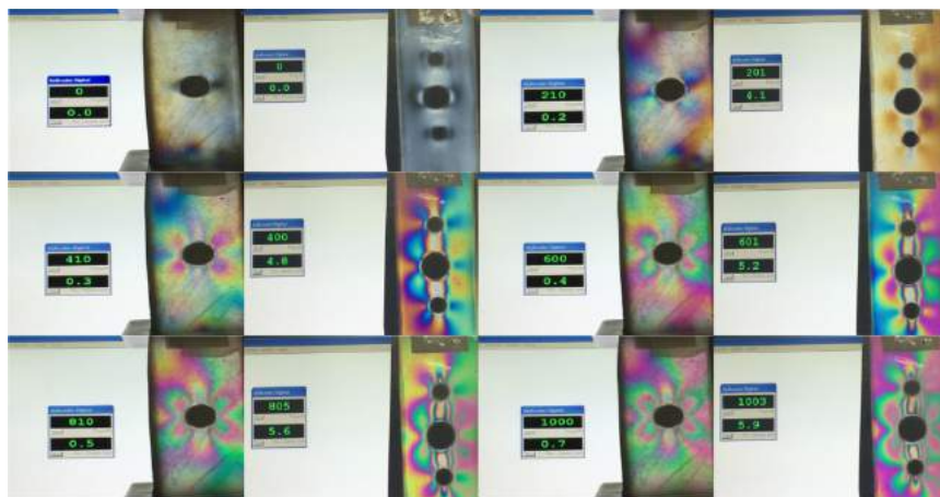
Figura 9. Comparação das franjas no corpo CPB, com um furo e com três furos, quando submetido a uma mesma carga de tração
