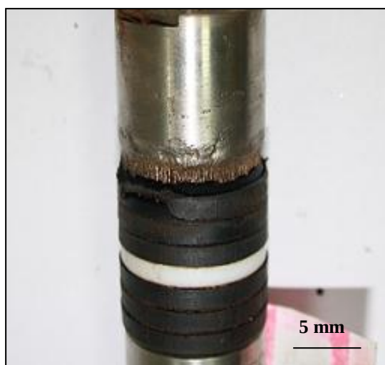
Figura 5. Danos em superfície de componente fabricado em aço AISI 316, constituído de marcas longitudinais típicas de reação com eletrólito.
