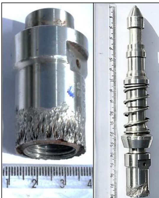
Figura 8. Danos na válvula construída de AISI 316, retirada do poço com aspecto rugoso e perda de material em região específica.
