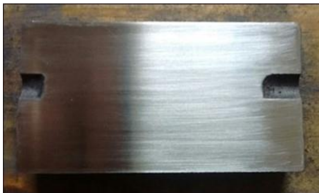
Figura 6 – Amostra de AISI P20 lixada (320 \mu m). Autoria própria (2017)
