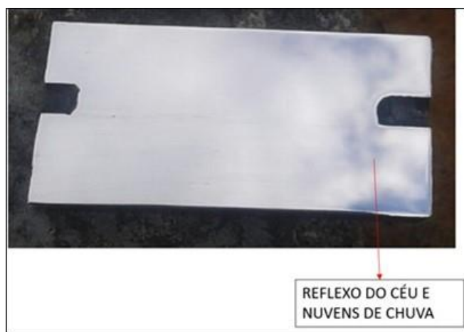
Figura 7 – Amostra de AISI P20 espelhada. Autoria própria (2017)
