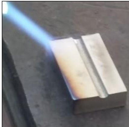
Figura 3 – Amostra do AISI P20 usinada e sendo pré-aquecida. Autoria própria (2017)
