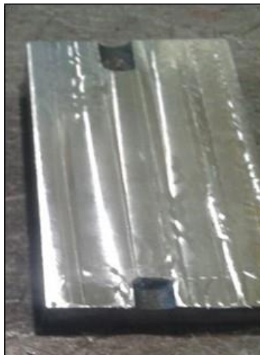
Figura 5 – Amostra de AISI P20, já usinada. Autoria própria (2017)
