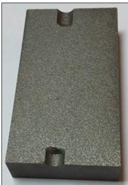
Figura 8 – Amostra de AISI P20 texturizada por ataque fotoquímico. Autoria própria (2017)
