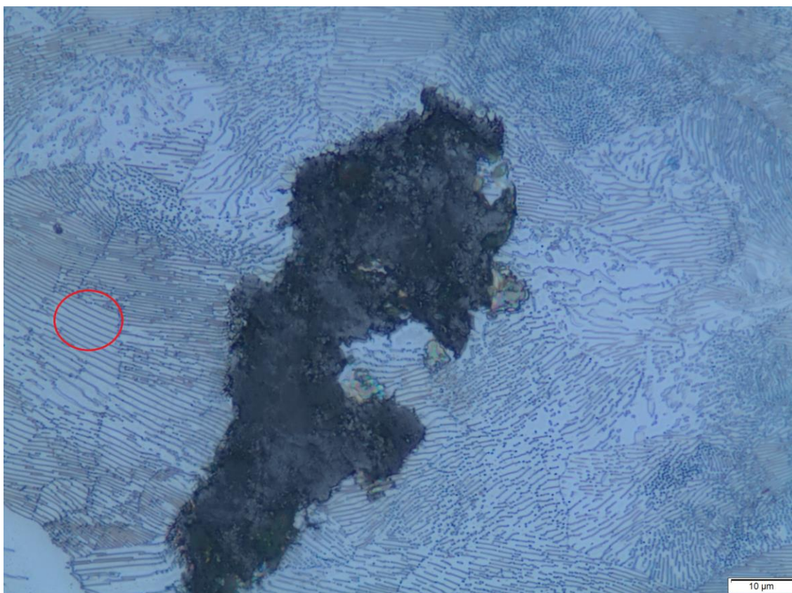
Figura 4. Grafita bidimensional envolvida pela matriz perlítica.
