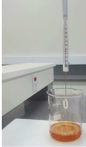
Figura 4. Medição da tensão superficial.
