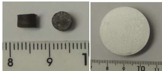
Figura 1.A) Pino de WC, B) Discos de AISI 4140
