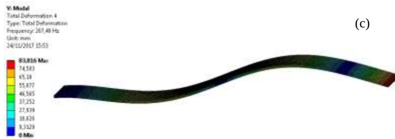
Figura 5. Modos de vibração de flexão através da simulação por elementos finitos: (a) Wn1 11,828Hz; (b) Wn2 74,091Hz; (c) Wn3 207,49Hz.
