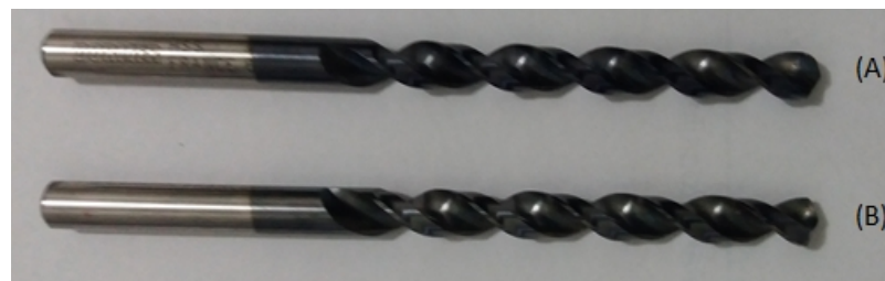
Figura 4. (A) broca com revestimento do composto de TiAlN; (B) broca com revestimento do composto de CrAlN.
