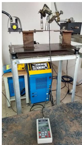
Figura 1. Ilustração da bancada vibratória para execução das soldagens
