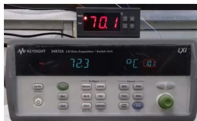
Figura 5. Estabilização das temperaturas no controlador e na unidade de aquisição
