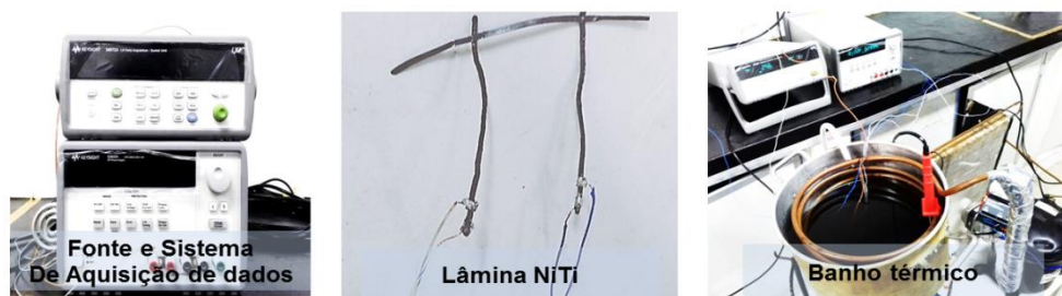
Figura 6. Lâmina de NiTi conectada a fonte elétrica e imersa no banho térmico
