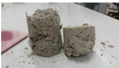
Figura 7. Corpo de prova com maior composição de bagaço de cana de açúcar rompido antes do ensaio.
