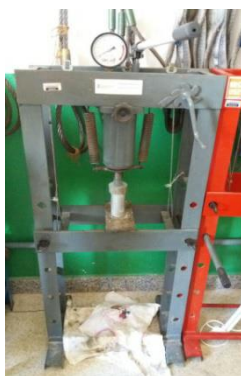
Figura 2. Corpo de prova na prensa.
