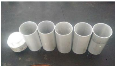
Figura 1. Moldes dos corpos de provas e peça prensadora.
