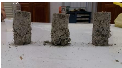
Figura 6. Corpo de prova com maior composição de bagaço de cana de açúcar fragmentado.
