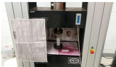
Figura 5. Corpo de prova na máquina universal de ensaios.
