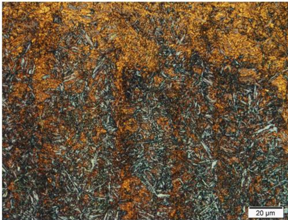
Figura 3 - Micrografias obtidas por microscopia ótica apresentando a microestrutura da amostra 3, martensita nas regiões de cor marrom e bainita das regiões azuladas, em (a) 200X, em (b) 500X e em (c) 1000X.
