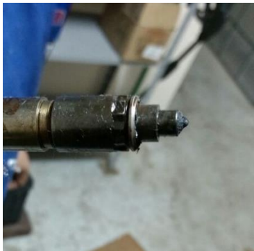
Figura 3. Bico injetor carbonizado em consequência da utilização de óleo S500 com elevado teor de enxofre. Fonte: Autoria própria.
