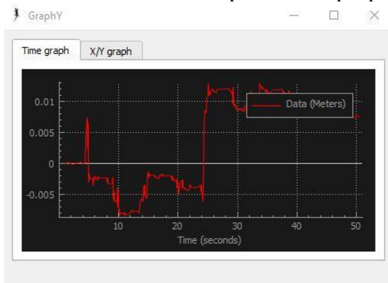
Figura 9. Gráfico do deslocamento no eixo Y para o movimento pitch-pitch .
