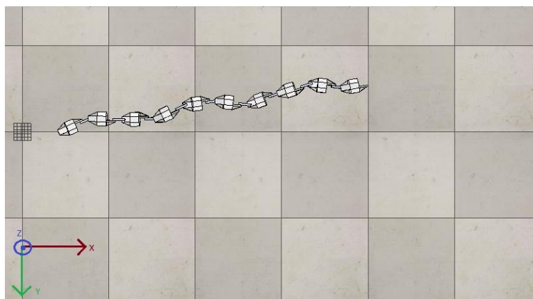
Figura 11. Posição do robô após 50 segundos da simulação do movimento sidewinding .
