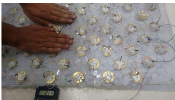
Figura 5. Geração de energia de todo o sistema
