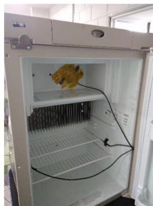
Figura 1. Refrigerador utilizado e sensores posicionados em seu interior.
