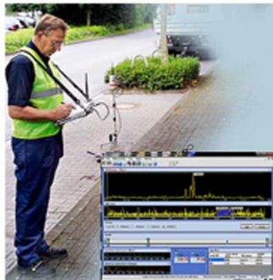
Figura 2: Exemplo de uso de um Correlacionador de Sinais e sua complexa existentes e sua interface gráfica. (Sewerin2015)
