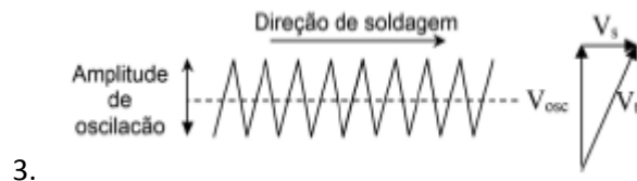
Figura 2 - Esquemático do movimento descrito no tecimento triangular
