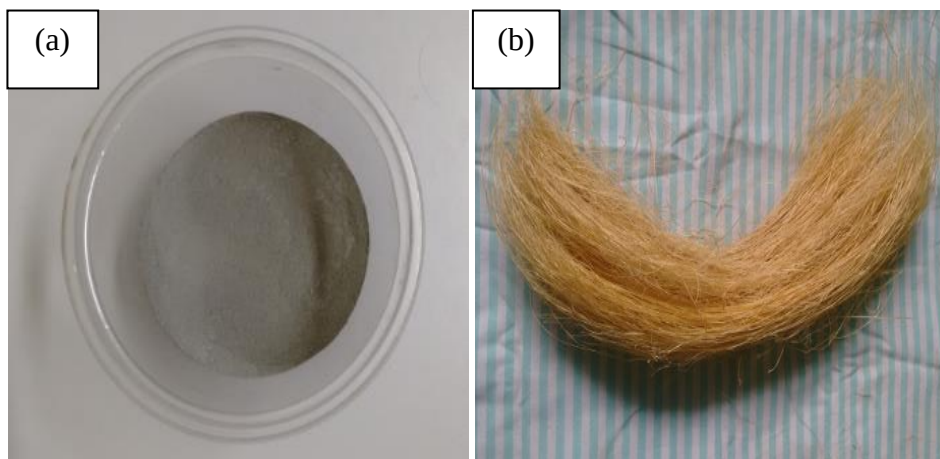
Figura 1: Materiais. (a) Resíduo de cobre após o peneiramento; (b) Fibras de Bambu.
