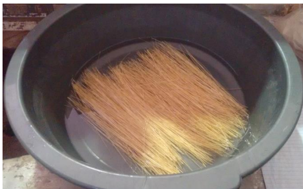
Figura 2: Fibras de bambu em solução alcalina de hidróxido de sódio.
