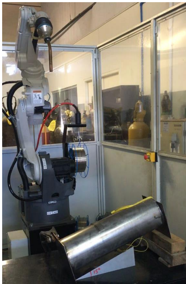
Figura 5. Tubo em AISD UNS S32760 e robô de soldagem Panasonic.
