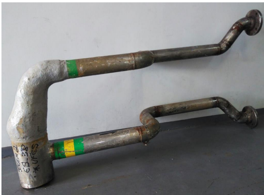
Figura 3. Trecho defeituoso com a bandagem de compósito polimérico.
