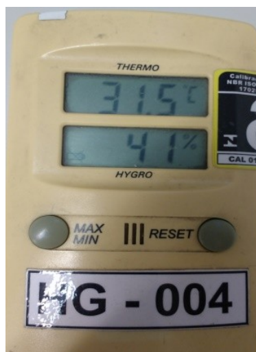
Figura 3. Termo-higrômetro utilizado para medição de umidade e temperatura ambiente.
