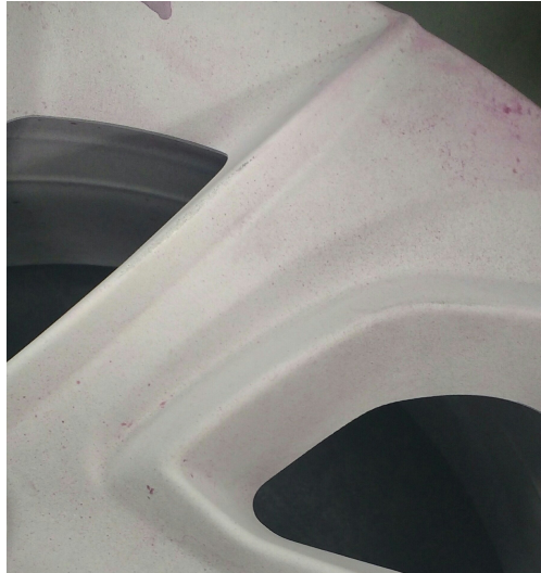
Figura 2. Porosidade na amostra encontrada por meio do ensaio de líquido penetrante.
