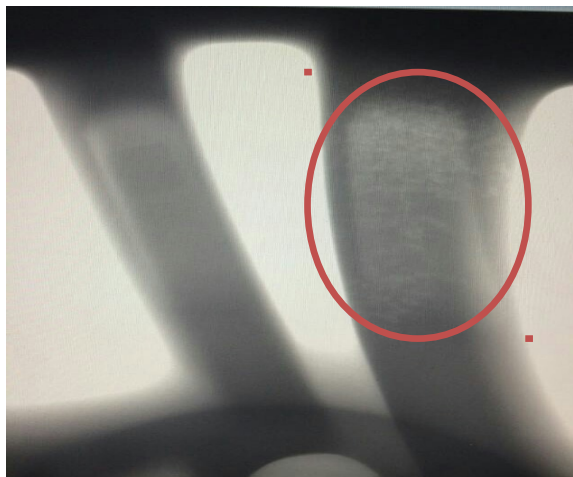
Figura 1. Porosidade em uma amostra encontrada por meio da análise de raio-x.
