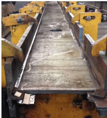
Figura 7 - Representação da soldagem na posição 2F
