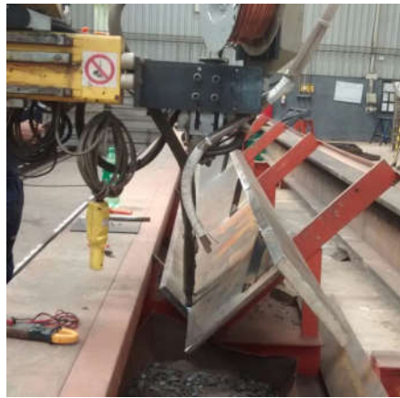
Figura 6 - Representação da soldagem na posição 1F
