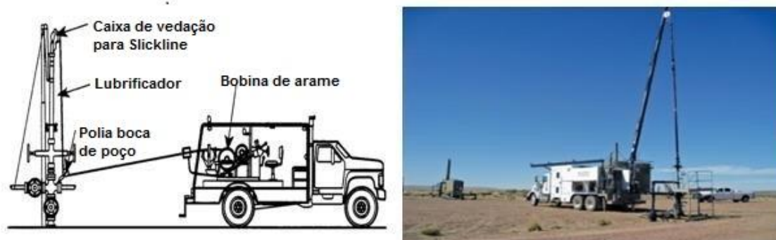
Figura 1: Esquema de montagem de Slickline.
