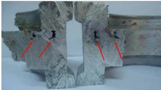
Figura 5: Rechupes encontrados indicando problemas de fundição do material.
