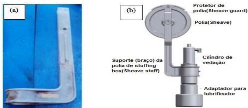
Figura 2: Objeto da análise. (a) Sheave staff desmontado; (b) Sheave staff montado no stuffing box.
