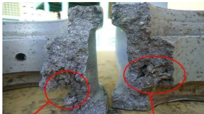
Figura 4: Inclusão de corpo solidificado na fusão do metal.
