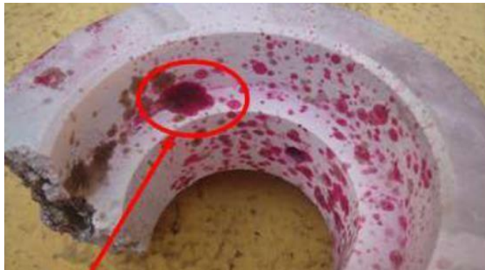
Figura 6: Poros encontrados no ensaio por líquido penetrante
