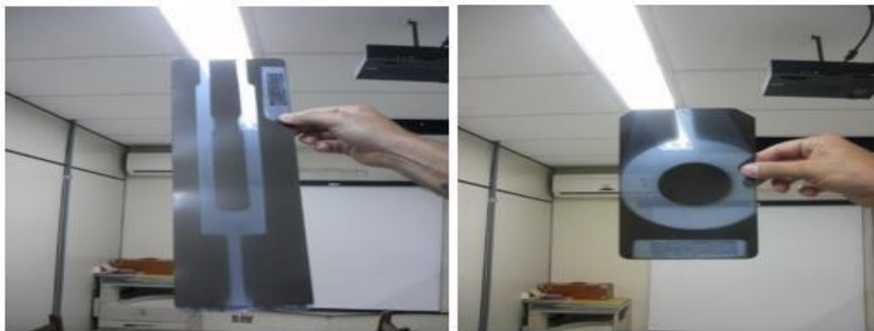
Figura 14: Ensaio de RX para detecção de possíveis discontinuidades praticamente inexistentes
