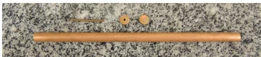
Figura 4. Componentes do tubo de calor para a soldagem.
