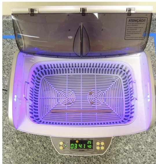
Figura 3. Limpeza dos componentes do tubo de calor no banho ultrassônico.
