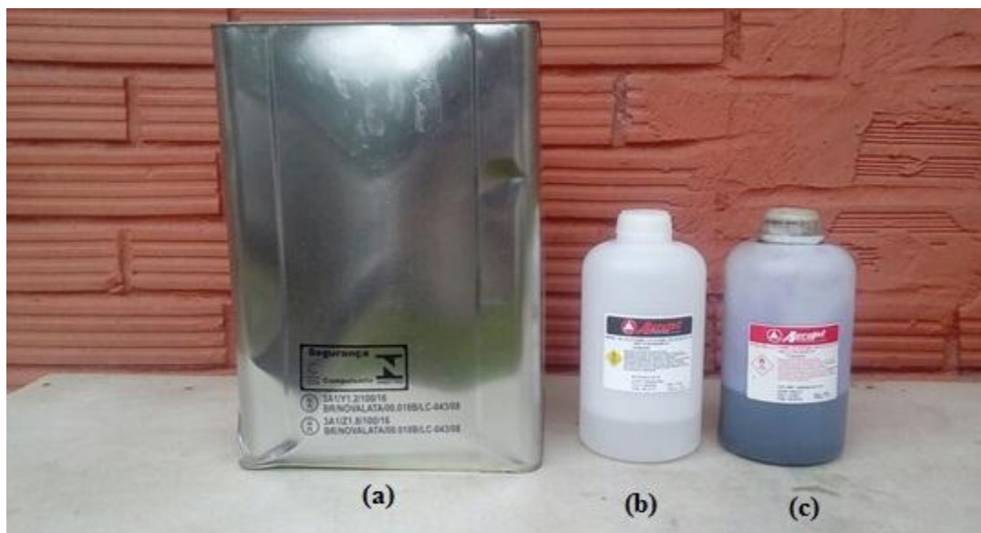
Figura 2. Materiais sintéticos: (a) resina poliéster insaturada, (b) acelerador de cura, (c) catalisador MEK-P.
