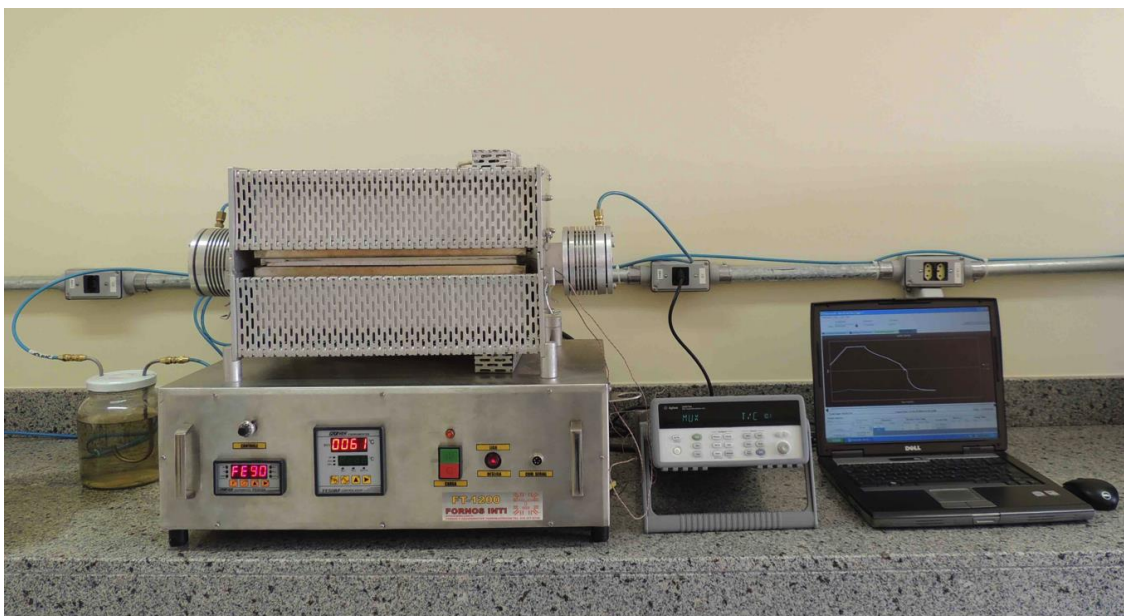
Figura 4. Aparato experimental do procedimento de sinterização.
