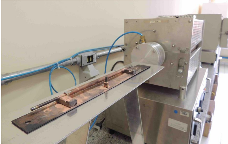
Figura 3. Preparação do tubo de calor para a sinterização.
