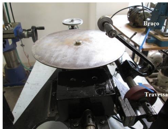
Figura 5: Sistema de fixação dos corpos de prova no tribômetro.
