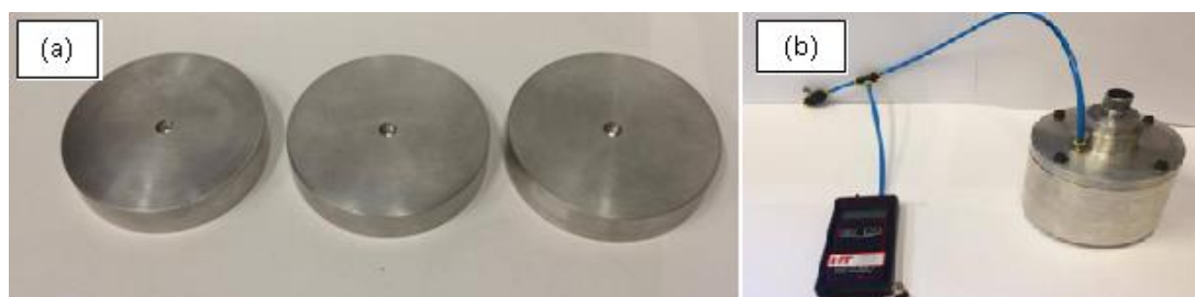
Figura 3. Discos para calibração (a); bancada para determinação da porosidade (b)
