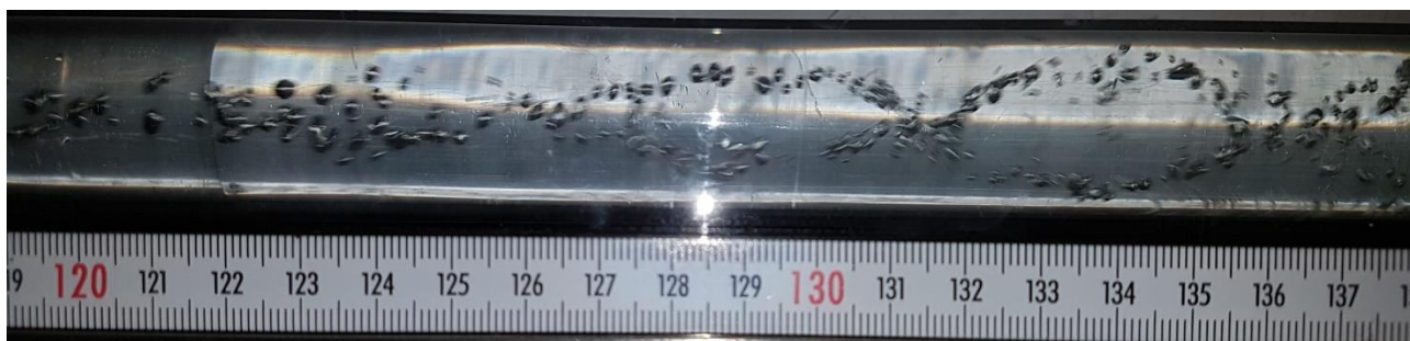
Figura 5. Visualização dos vórtices helicoidais induzido pela fita torcida y = 2 com Re = 4.08 \times 10^4 .
