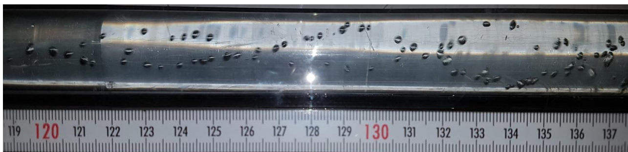
Figura 4. Visualização dos vórtices helicoidais induzido pela fita torcida y = 2 com Re = 2.72 \times 10^4 .
