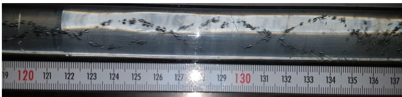
Figura 6. Visualização dos vórtices helicoidais induzido pela fita torcida y = 2 com Re = 5.45 \times 10^4 .
