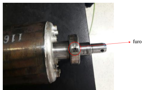
Figura 3. Falha inserida no rolamento.
