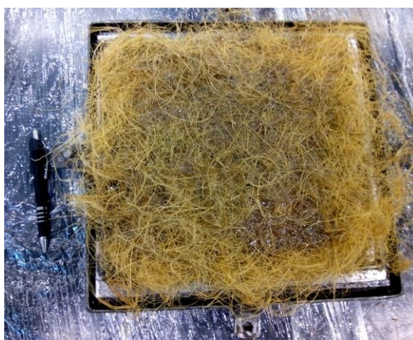
Figura 2. Aplicação da camada da fibra do epicarpo do coco.
