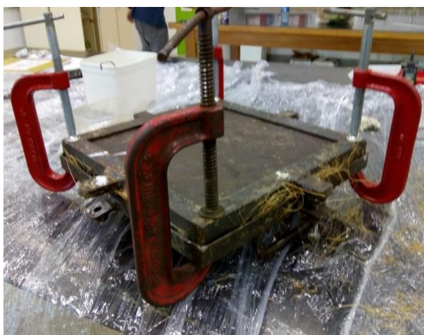
Figura 3. Fechamento do molde com auxílio de sargentos.
