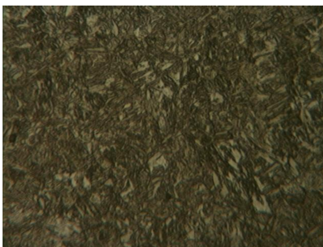
Figura 3. Micrografia do Aço H450 – Ampliação de 400x.
