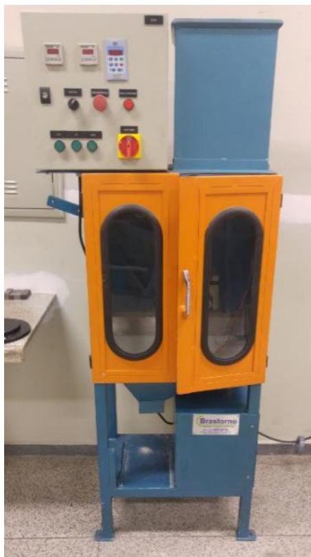
Figura 1. Máquina para ensaio de roda de borracha
