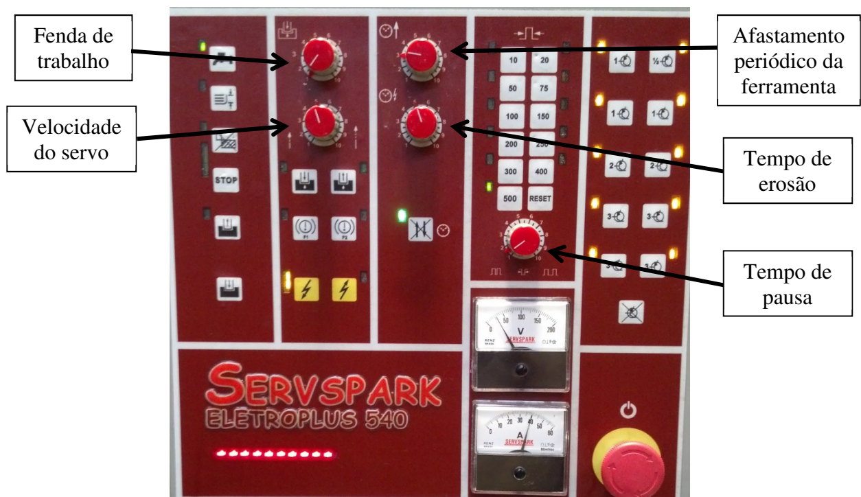
Figura 3. Painel de controle da máquina de eletroerosão com indicação dos parâmetros ajustados.
