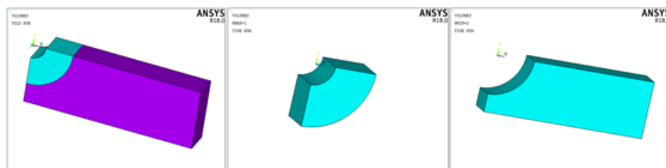
Figura 6. Representação de 1/8 do entalhe analisado dividido em 2 volumes.
