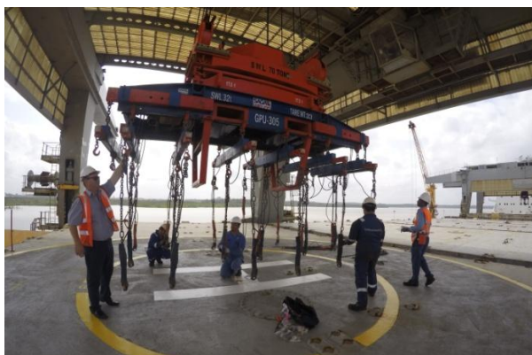
Figura 7 - Manutenção no Spreader
