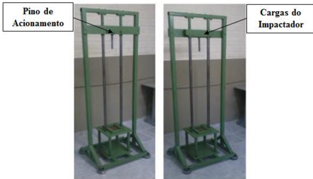
Figura 1 - Máquina de impacto por queda de peso para materiais compósitos (Galdino Junior, 2014).
