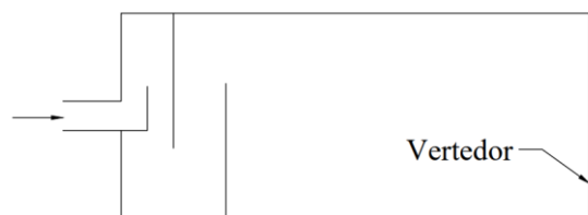
Figura 2. Geometria utilizada para a validação do modelo numérico inspirada no tanque retangular de configuração 3 de Siqueira (1998).
