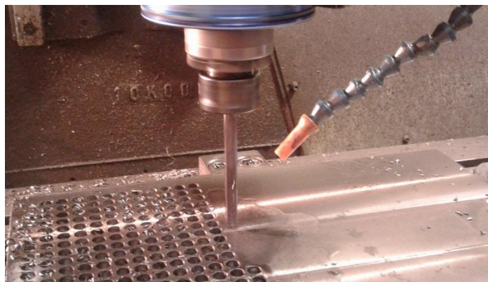
Figura 1. Aplicação de mínima quantidade de fluido de corte (MQL) na vazão de 22 ml/h.
