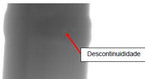
Figura 6. Radiografia do cordão de solda.
