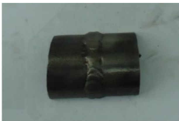
Figura 3. Junta soldada que apresentou falha.
