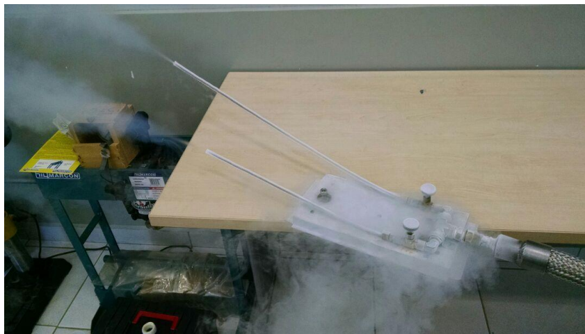
Figura 4: LN2 saindo pelos dois pontos de descarga do manifold durante pré-testes com o novo sistema.
