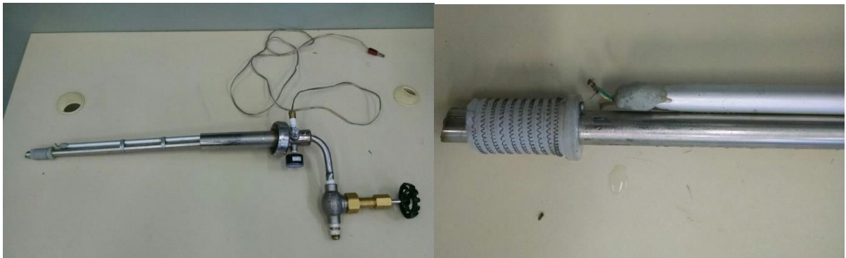
Figura 3: (a) Aspersor modificado com sistema de aquecimento por resistência elétrica; (b) Zoom mostrando a resistência elétrica envolta de uma peça de technyl®.
