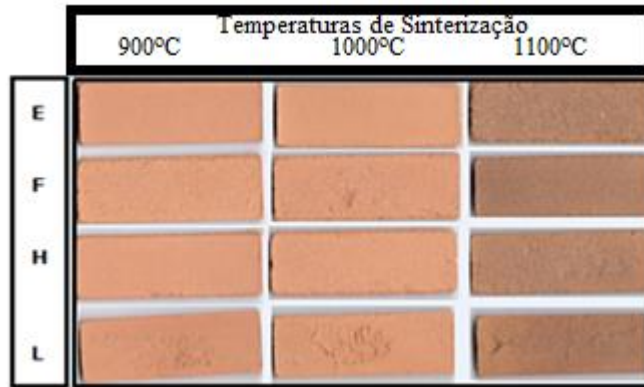
Figura 1. Corpos de prova sinterizados a 900°, 1000° e 1100°C, com taxa de aquecimento de 10°C/min.
