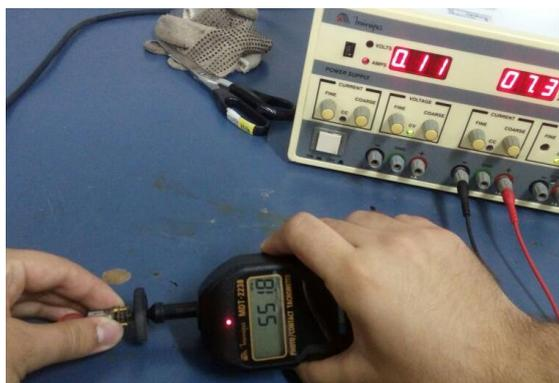
**Figura 7. Medição de velocidade angular com tacômetro.**
