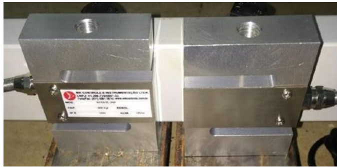
Figura 2. Duas células de carga do modelo CSAZL acopladas na esteira Caloi CLE50 Elite.
