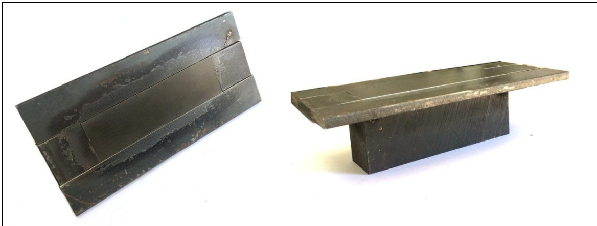
Figura 2. Chapas de aço SAE 8630 com abas fixadas antes do processo de amanteigamento.
