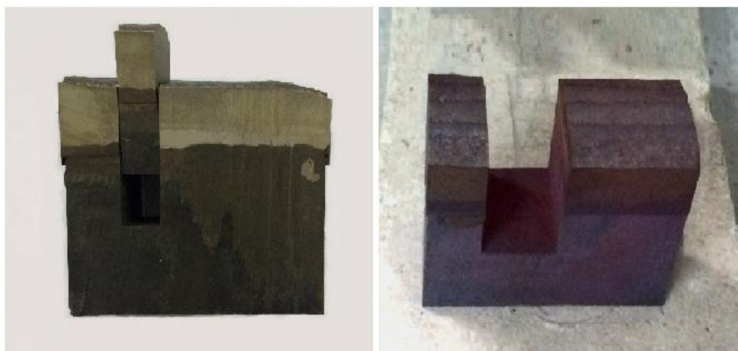
Figura 4. Aço SAE 8630M amanteigamento com Inconel 725. (a) Amostra sem TTAT; (b) Amostra com TTAT.
