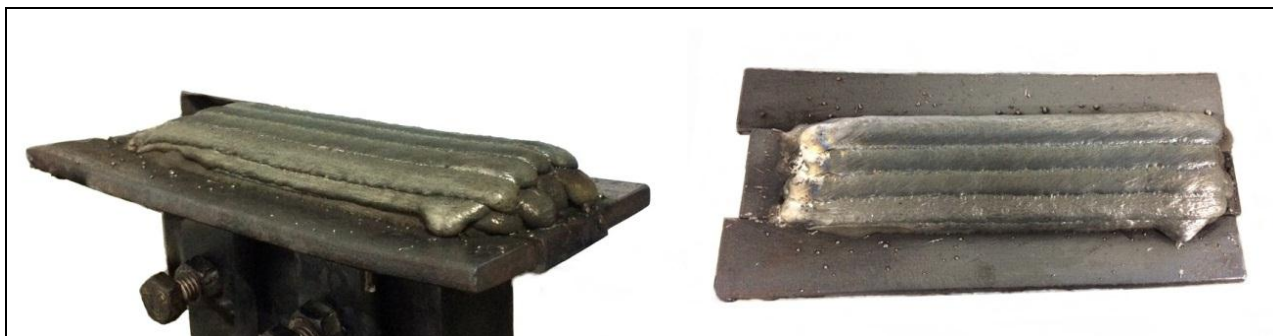
Figura 3. Amanteigamento da chapa de aço SAE 8630M com Inconel 725.
