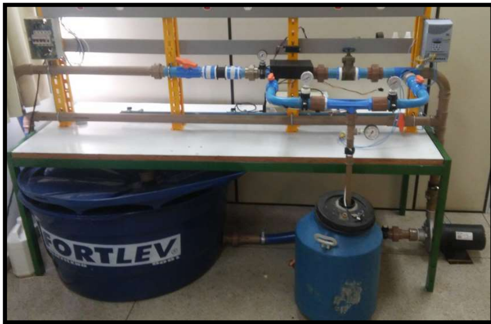
Figura 1. Bancada hidráulica construída para os experimentos.
