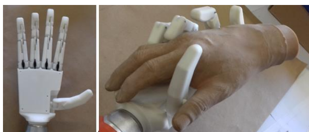
Figura 6. Posições atingidas, de abertura total a fechamento ajustável, no caso o aperto de mão em uma luva cosmética, que pode ser confeccionada sob medida (fotos do autor).
